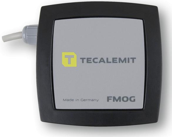
Der FMOG 150 ist ein nicht eichfähiger Durchflussmesser für strömende Flüssigkeiten nach dem Messprinzip eines Ovalradzählers. Er ist für den Einsatz als stationärer Zähler geeignet. Der Impulsgeber ermöglicht den Einsatz in einem Flüssigkeitsmanagementsystem.
